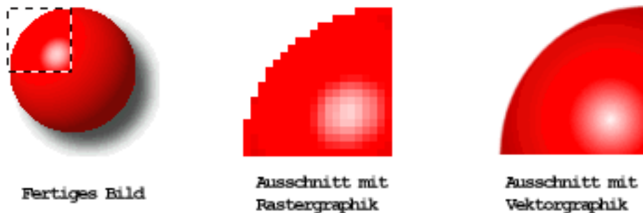
Abbildung 4.2: Unterschied Vektor- zu Rasterdarstellung
